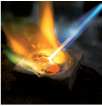
Die Gasflamme verflüssigt das Gold im Tiegel. Foto: Marcus Rebmann
